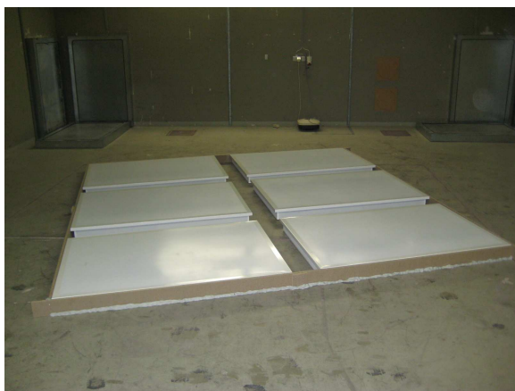
Bild 6: Versuchsanordnung zur Bestimmung des Schallabsorptionsgrades im bedämpften Hallraum des Fraunhofer IBP.
